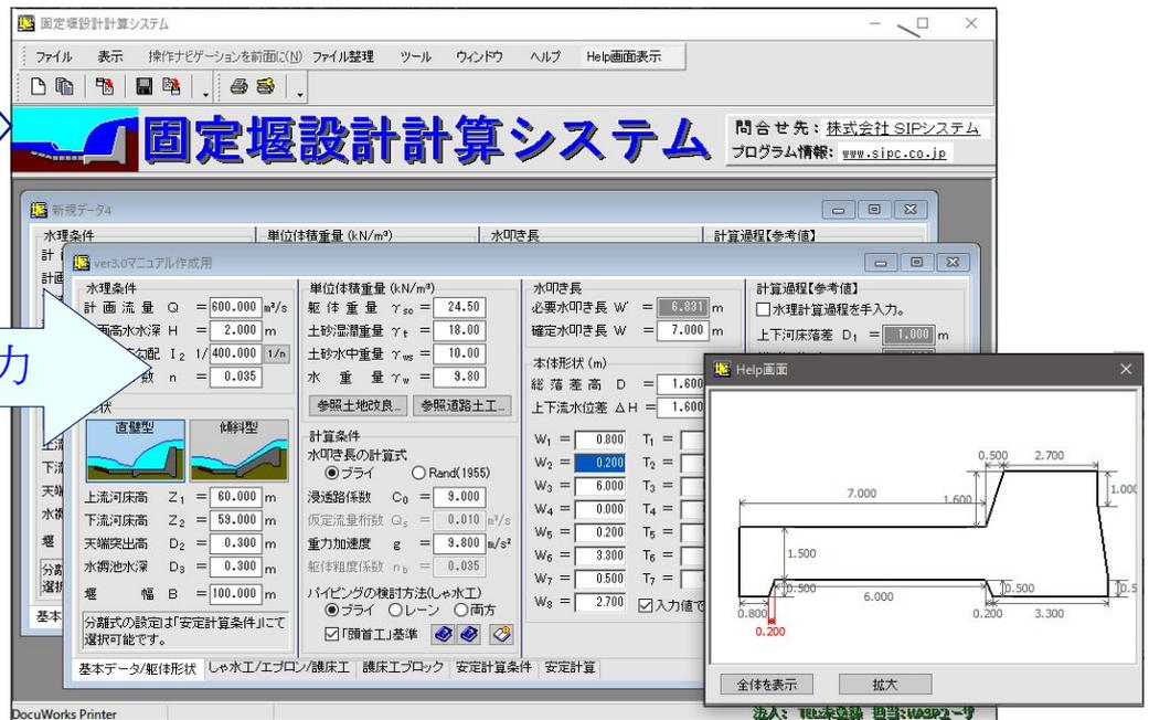
本システムは、頭首工/取水堰/固定堰に分類される固定堰の直壁タイプ（含む分離式）および傾斜タイプの水理計算や安定計算が可能。
