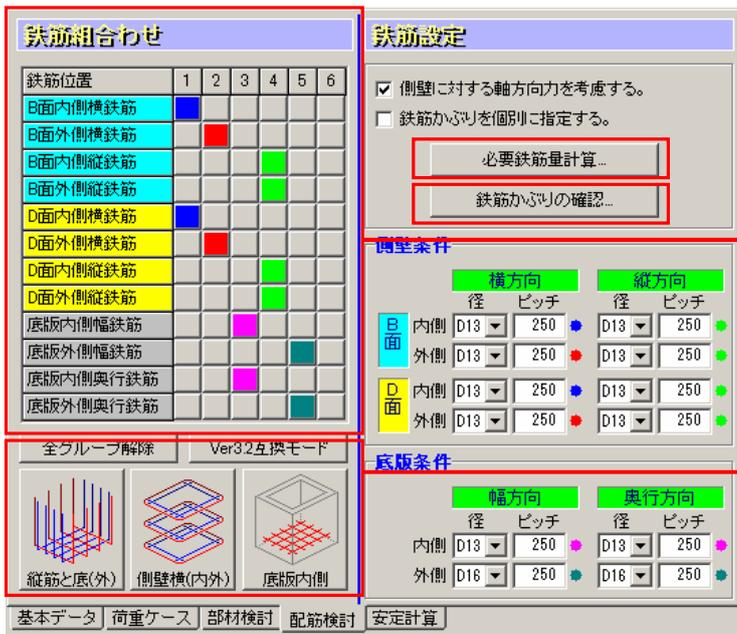
従来は、最大の断面力が発生する方向のみの鉄筋（主鉄筋）を決定し、そのクロス方向の鉄筋（配力筋）については、未検討としていましたが、今回の改良で全方向（12断面）の配筋検討が可能となりました。
